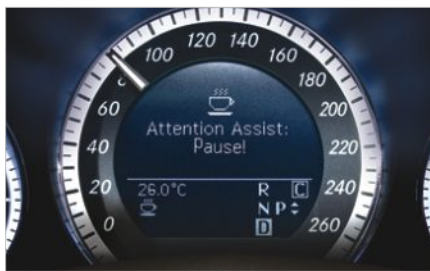
Hệ thống ATTENTION ASSIST phát hiện và cảnh báo tình trạng mệt mỏi của người lái
