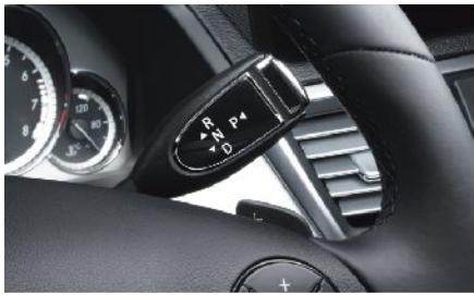
Hộp số tự động 7 cấp 7G-TRONIC với cần chọn số DIRECT SELECT tích hợp trên tay lái
